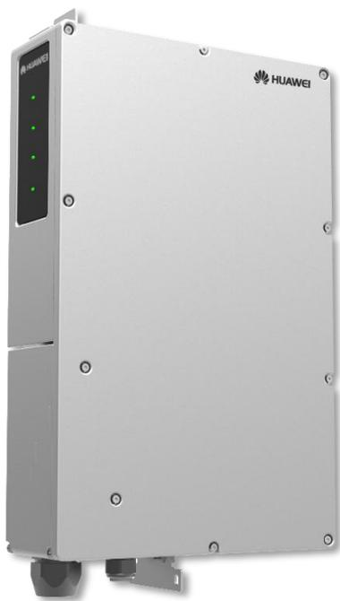
Модуль SmartPID2000 встановлюється в SmartACU2000D для зменшення негативного впливу деградації, викликаній потенціалом (PID), і підтримує безперервний контроль ізоляції DC і AC за допомогою опціонального модуля SmartIMD.
